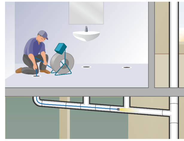
Slutdokumentering efter relining
